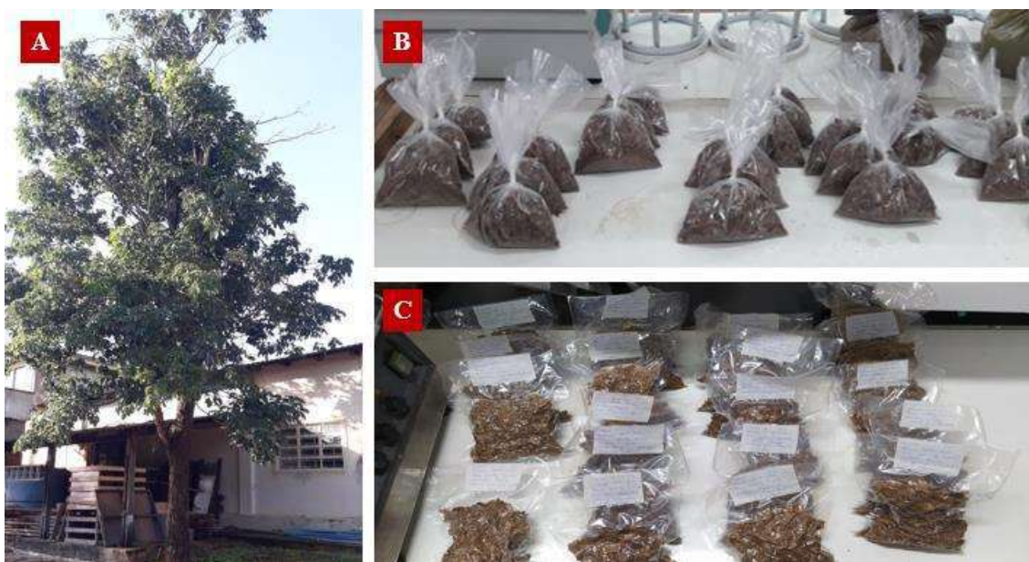
Figura 1: Obtenção das amostras de serragem do cerne do Ipê Roxo, onde (A) apresenta a árvore utilizada, em (B) as amostras embaladas em embalagem plástica comum, e em (C) as amostras embaladas a vácuo em embalagem plástica apropriada.
