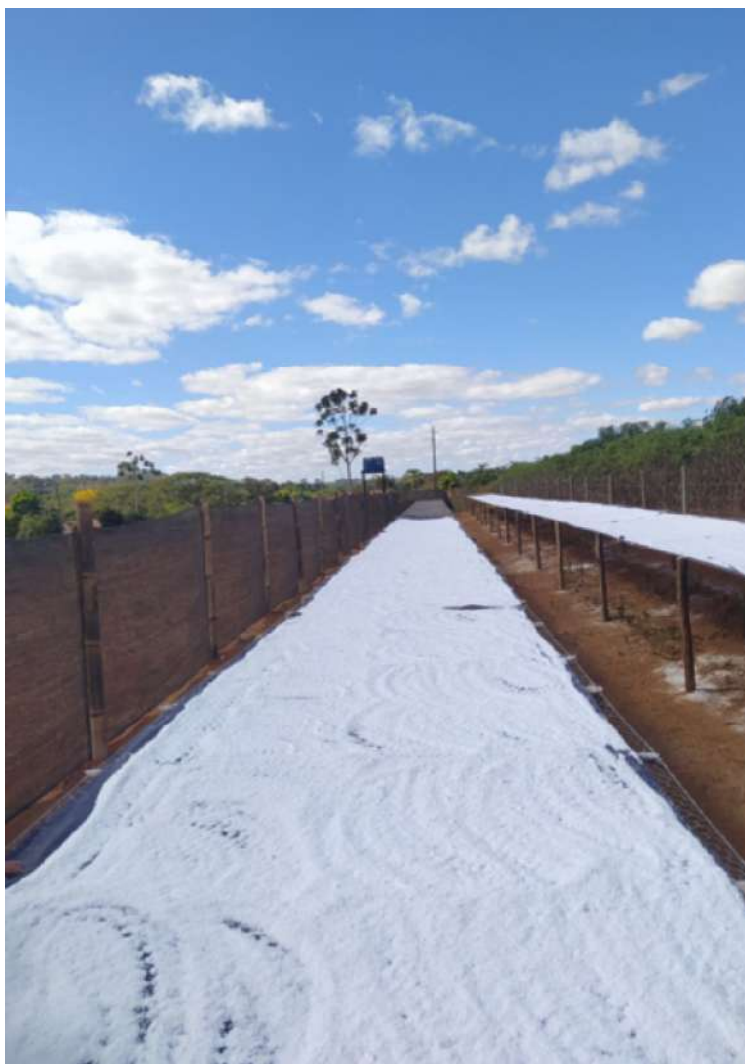
Figura 2. Secagem de polvilho ao Sol em unidade de processamento de polvilho na Região do Cará, em Bela Vista de Goiás.
