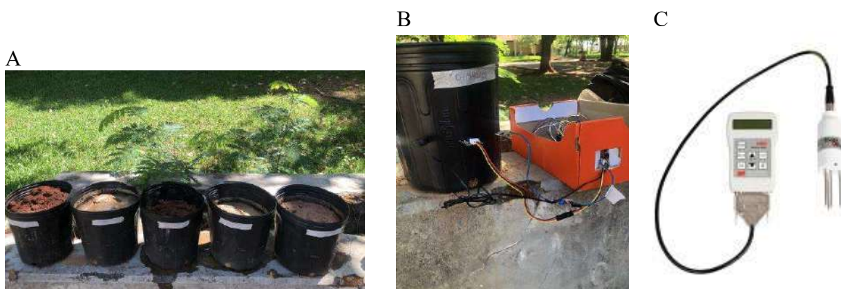
Figura 1. (A) Vasos plásticos com as amostras dos solos saturadas. (B) Leitura de valores brutos com os sensores controlados pelo arduino. (C) Sensor TDR de referência.
