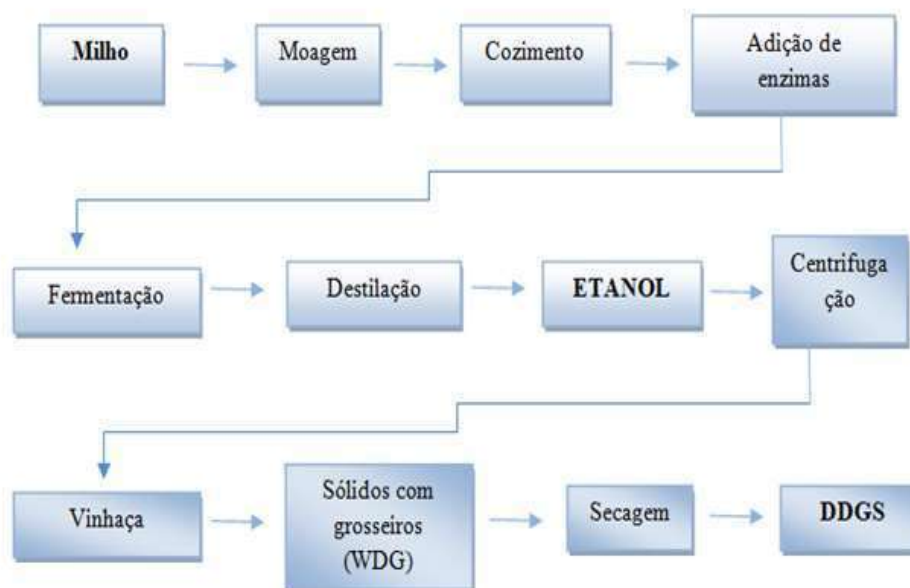
Figura 1. Fluxograma do processo de obtenção do DDGS. Fonte: Adaptado de Silva et al. (2015).
