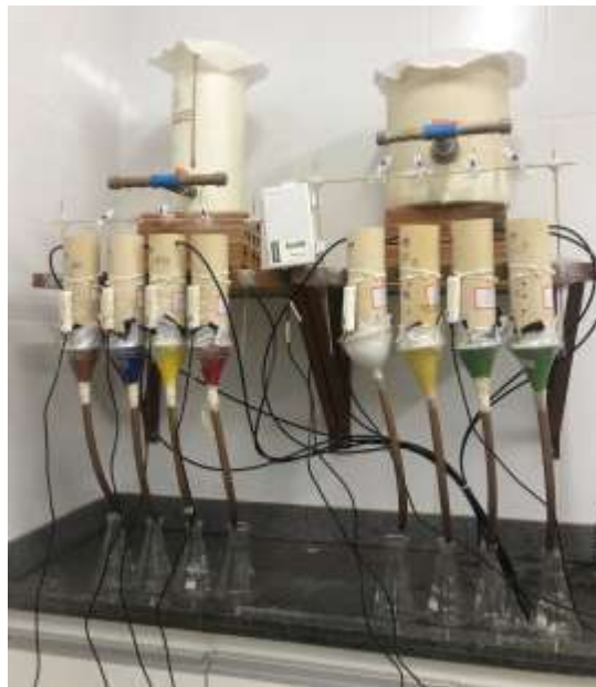
Figura 1. Bateria de ensaio da coluna de solo com aplicação das vinhaças in natura e tratada e água destilada
