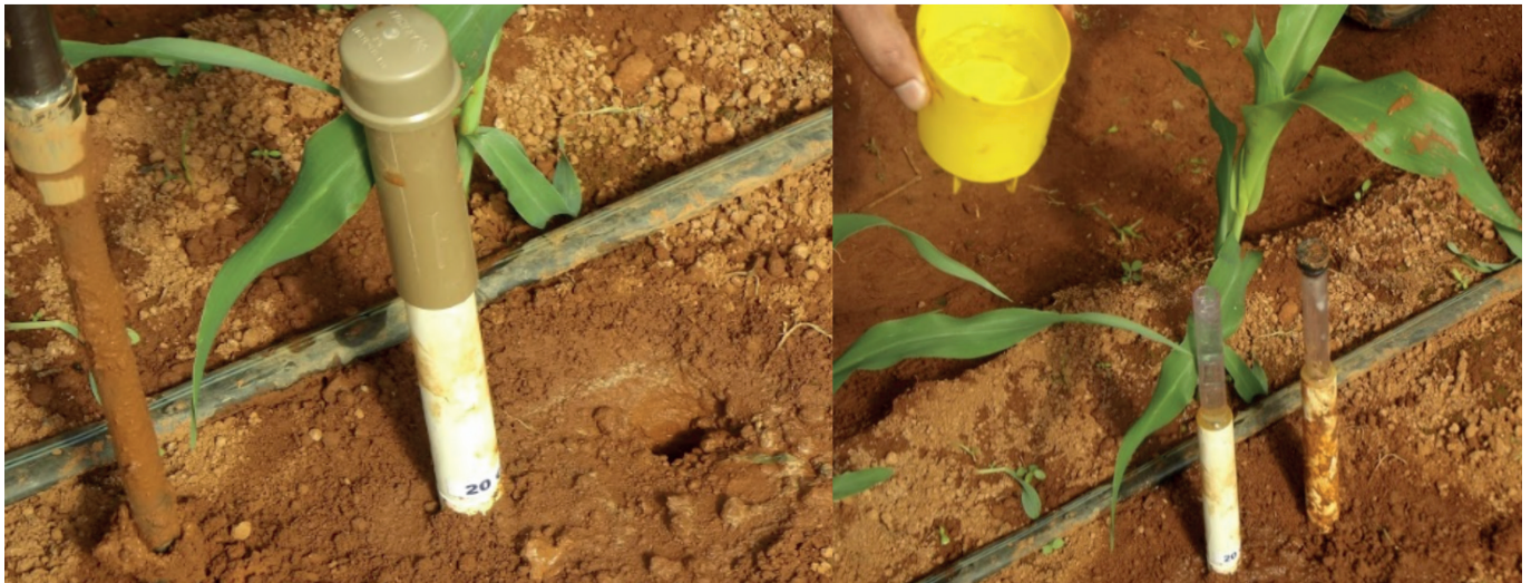
Figura 5. Instalação dos tensiômetros em diferentes profundidades para a realização do manejo da irrigação. Fonte: ARAÚJO, A. L. G. (2015).
