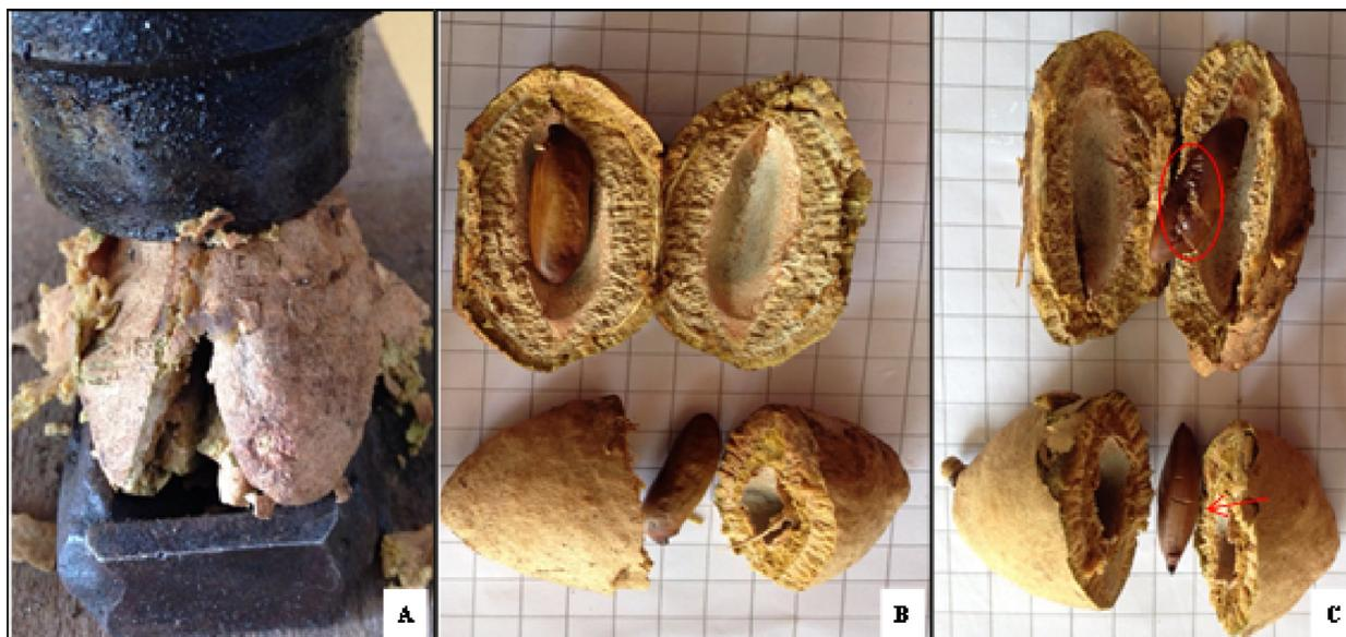
Figura 4 - A - esmagamento do fruto de baru pelo excesso de força na prensagem; B - sementes intactas de baru, por ambos os métodos de extração; C - sementes danificadas de baru, por ambos os métodos de extração.
