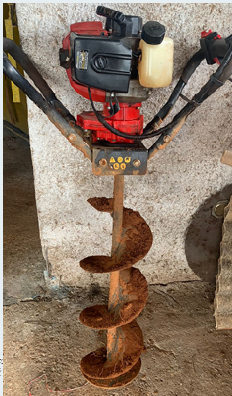
Figura 1 – Moto-Perfurador Helicoidal de Solo Manual modelo Toyama TEA52X
