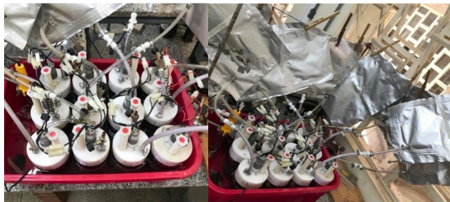
Figura 5. Fotografias dos biorreatores de bancada 1,3 L após montagem. Fonte: Autores.
