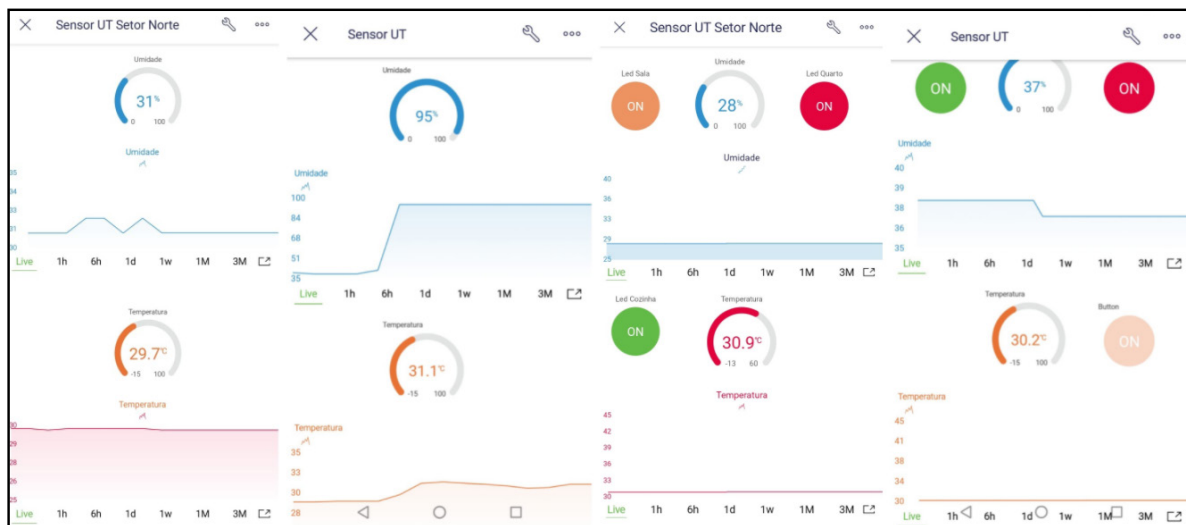
Figura 4: Projetos concluídos - interface de coleta e controle de dados nas telas dos smartphones dos discentes
