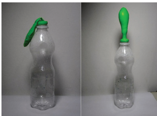
Figura 1: Expansão do ar em uma garrafa por meio de aquecimento. Fonte: do autor.
