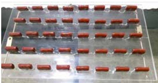
Figura 1 – Banco de capacitores cerâmicos de 330 \mu\text{F} e 1600 V associados em paralelo com resistores 0,5 W e 10 M \Omega .
