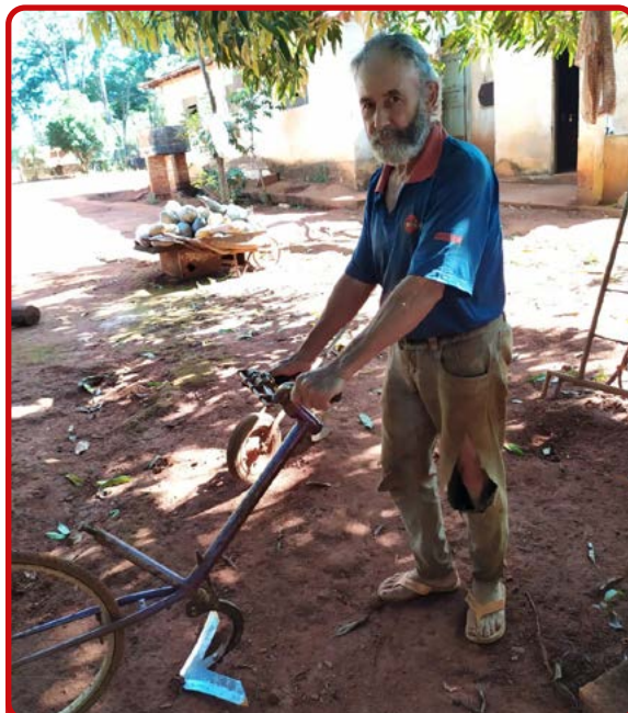
Agricultor familiar de Hidrolândia com o cultivador-capinador agrícola manual desenvolvido para fazer sulcos e carpir em sistema de produção de milho.
